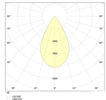
Quadratisches Downlight für Innenanwendung · IP20 · Hochwertige Optik aus PMMA zur präzisen Lichtlenkung mit sehr guter Entblendung, UGR≤19 · Ausstrahlungswinkel 60°, Optional 13°, 18°, 24° und 36° · Homogene symmetrische Ausleuchtung · CRI ≥ 80 · Lebensdauer L80/B10 ≥ 50.000 h · Lichtfarbe 3.000 oder 4.000 K · Lichtstrom 1.000, 1.400, 2.100 oder 2.600, 3.300 lm.
